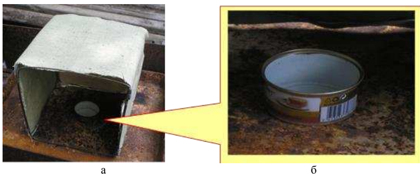
Рис. 3. Модельний осередок пожежі
