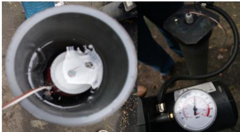
Rys. 3. Uzbrojony w zapalnik ładunek MWE umieszczony w rurze testowej z wodą (po prawej wytworzenie nadciśnienia w układzie za pomocą kompresora)
