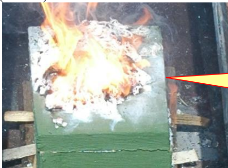
Рис. 2. Результати випробувань модельного зразка обробленого вогнезахисним покриттям на неорґанічній основі.
