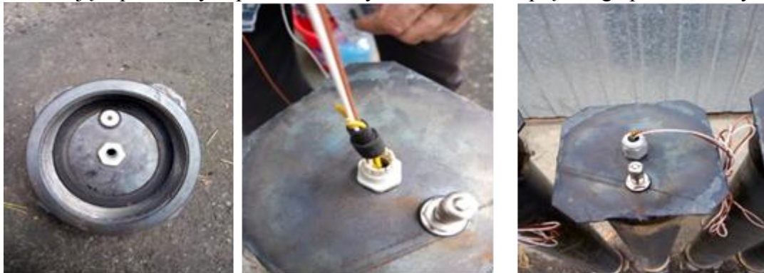
Rys. 2. Sposób uszczelniania kryzy i przewodów zapalnikowych
