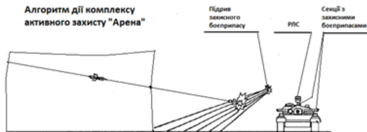
Рис. 1. Комплекс активного захисту танків «Арена»
