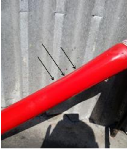
Rys. 5. Widoczna deformacja ładunku wyjętego z rury testowej
