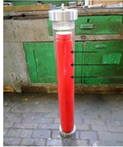
Rys. 6. Rura ciśnieniowa wykonana z plexi
